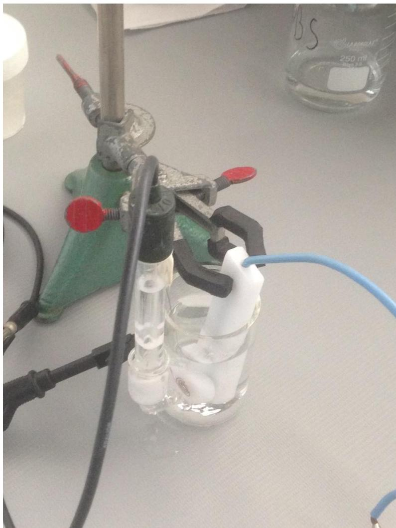
Figura 20 - Disposição dos eletrodos para realização da polarização potenciodinâmica.
