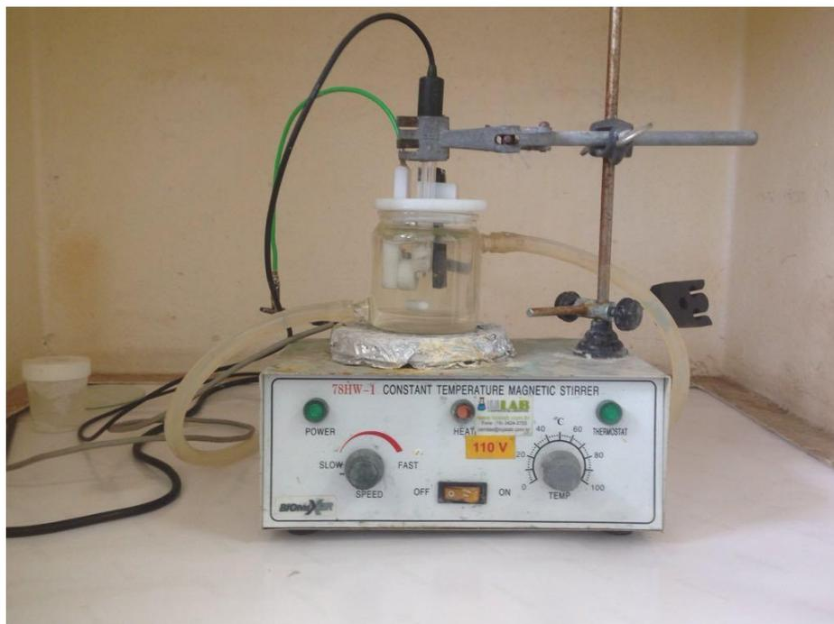
Figura 18 - Célula eletrolítica de três eletrodos utilizada na eletrodeposição.
