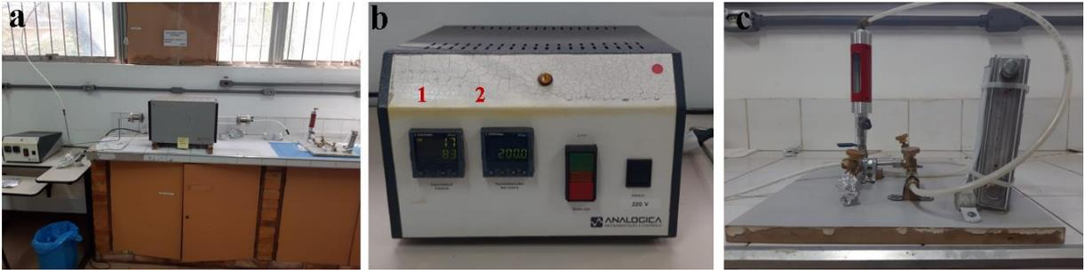
**Figura 1:** (a) Forno CVD e o tubo de quartzo utilizado para a síntese do MoS<sub>2</sub>. Em (b) temos o controlador de temperatura junto a (1) unidade de programação e (2) estrutura de suporte e retorta. Em (c) vemos o fluxômetro.
